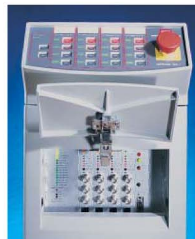
Для оперативности и удобства работы все часто используемые соединители каналов размещаются на передней панели контроллера.
