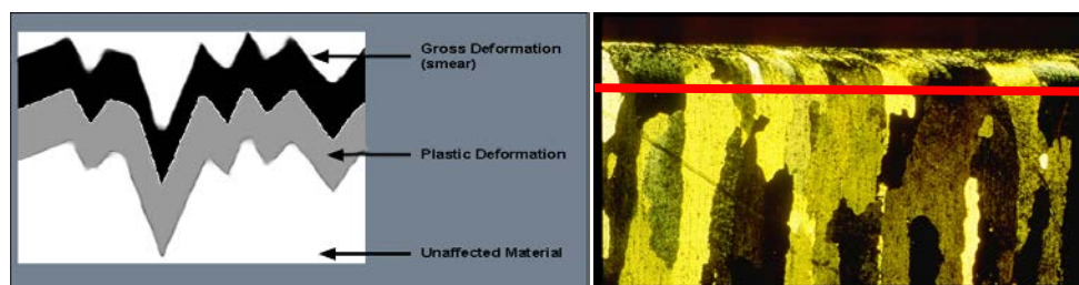
Figure 1 Нежелательная деформация поверхностного слоя образца, образующаяся в процессе механической обработки
